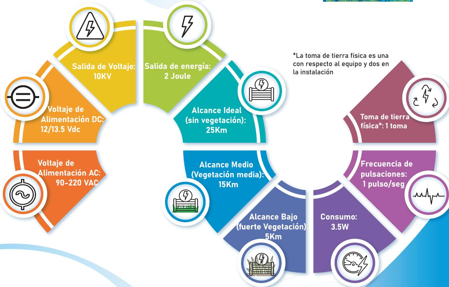
\*La toma de tierra física es una con respecto al equipo y dos en la instalación
